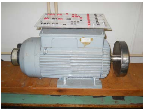
Мотор је са номиналним подацима и тахогенератором
